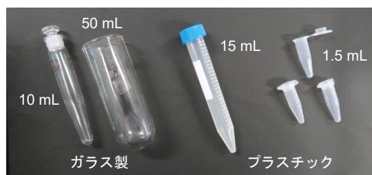
図4. 遠心分離機に用いる様々な市販の遠沈管・マイクロチューブ
