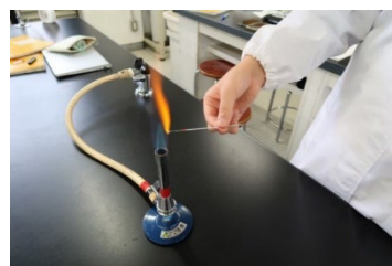
図7. プレキャリブレードピペットの密閉 (溶液をキャピラリー内に入れ、ガスバーナーでガラスを溶かして封じた)
