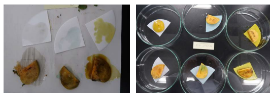
図 6. カキの実の断面に金属塩の水溶液を浸す実験の様子
