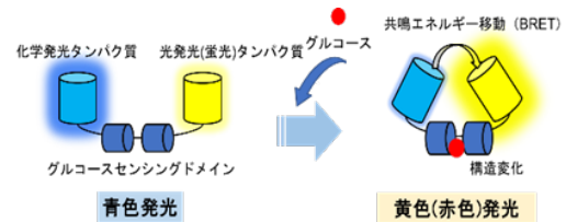
図4 センサーの発光色変化原理
