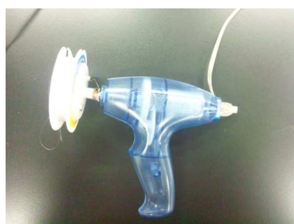
図2 改良した手回し発電機
