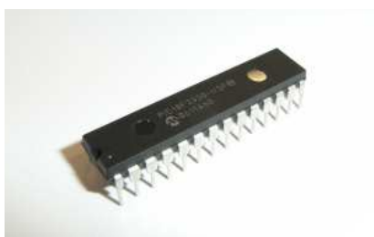
図6 PIC マイコン PIC18F2320
