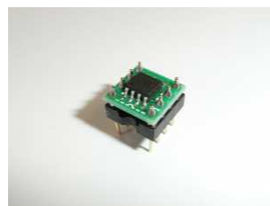
図4 スイッチング用 FET (N-ch MOSFET \mu\text{PA2753} )
