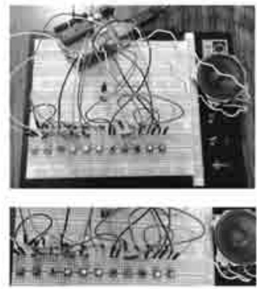
図 1:作成した簡易電子ピアノとタクトスイッチ部分(鍵盤)の拡大写真
