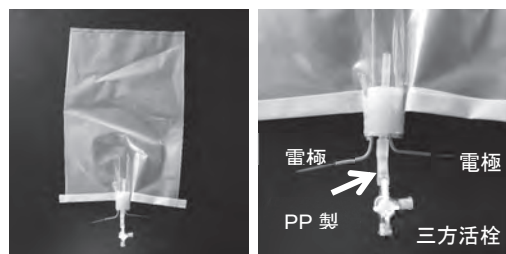
図4. 反応容器 (PE袋) と自作コック 放電用の2本の電極と気体を入れるための管を通してている。
