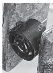
図3 超音波振動子 中心周波数: 40KHz±1KH 音圧: 116dBm min@10Vrms,30cm
