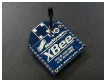
図 19 ZigBee モジュール (写真は XBee モジュール)
