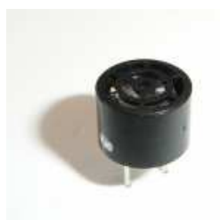
図2 超音波スピーカー 直径約 10mm
