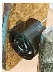
図3 超音波振動子
