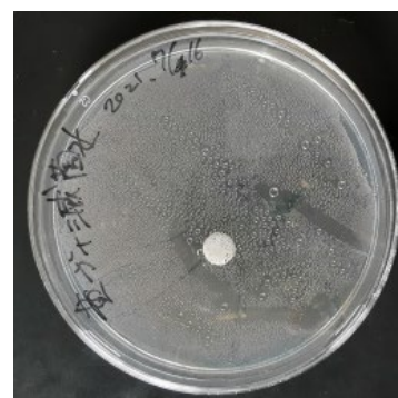
図5 S.aureus の滅菌水に対する反応 陰性対照実験。ディスクの周りに阻止円は確認されなかった。
