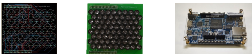
図 1 : 作成した超音波発信器と FPGA
