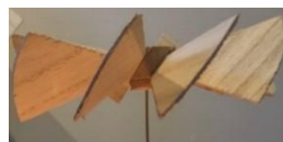
図5. 制作した8枚羽プロペラ 53°
