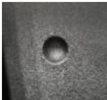
図7. 上昇気流によって形成された窪み
