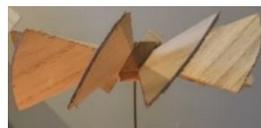
図5. 制作した8枚羽プロペラ 53°
